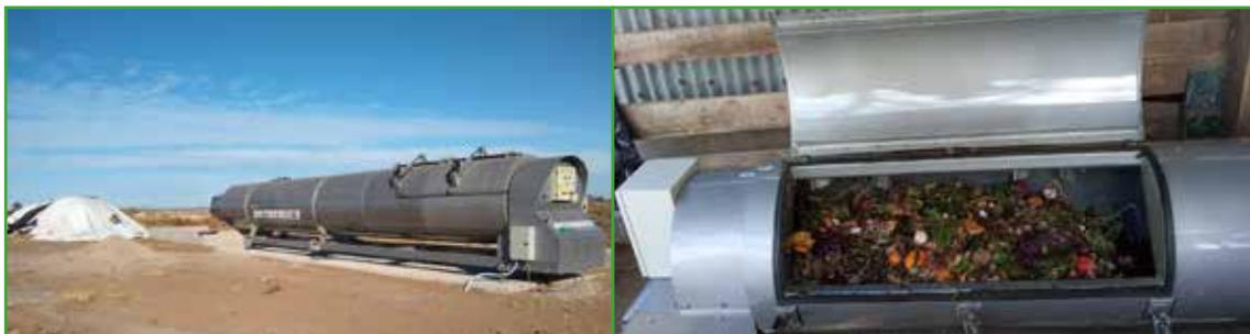
Figura 2: Rotorbuey para el compostaje de residuos de alimentos.
