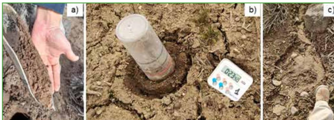
Figura 2: a) Suelo húmedo en primavera. b) Medición del índice de infiltración. c) Surco de escurrimiento superficial de agua.
