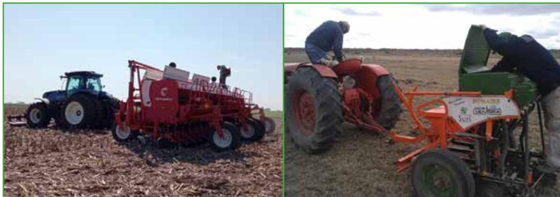
Figura 3: Izquierda: sembradora convencional a gran escala, siembra de soja (localidad de Bragado). Derecha: sembradora de pequeña escala, siembra de agropyro y lotus tenuis (localidad de Maquinchao).
