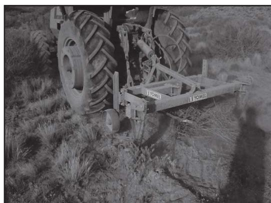
Figura 3: Primeras experiencias de subsolado en Línea Clave. Estancia Calcatre, 2015.
