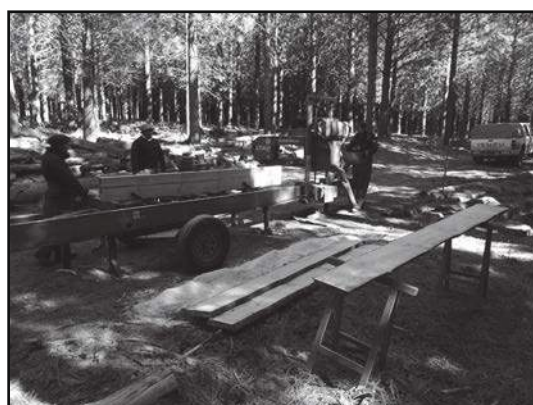
■ Foto 3: Aserrado de la segunda troza con aserradero portátil.
