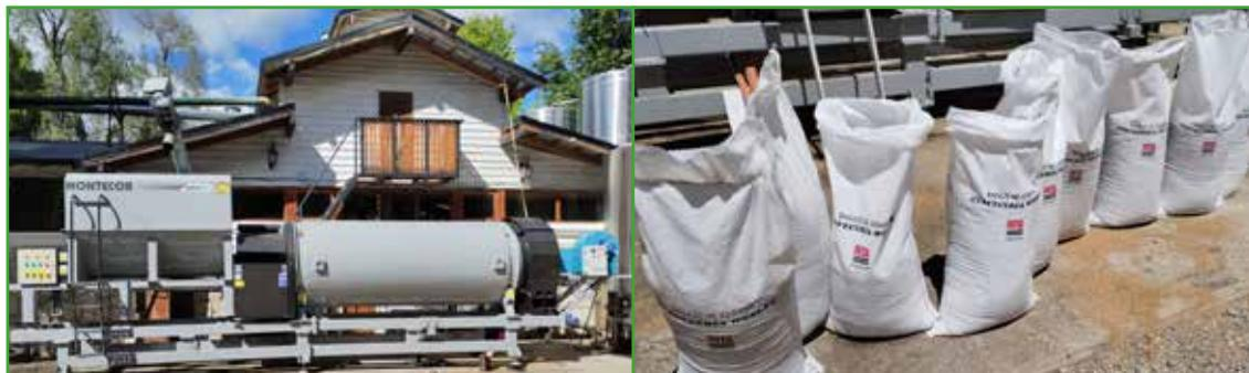
Figura 3: Extrusor - Secador de bagazo de cebada en Cervecería Wesley, Bariloche. Izquierda: Equipo instalado. Derecha: Bagazo seco embolsado para la distribución.
