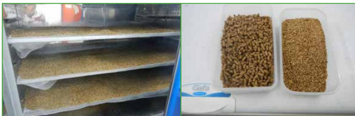
Figura 1: Secado y peletizado de bagazo. Izquierda: Secado en estufa. Derecha: Peletizado en pequeña escala.
