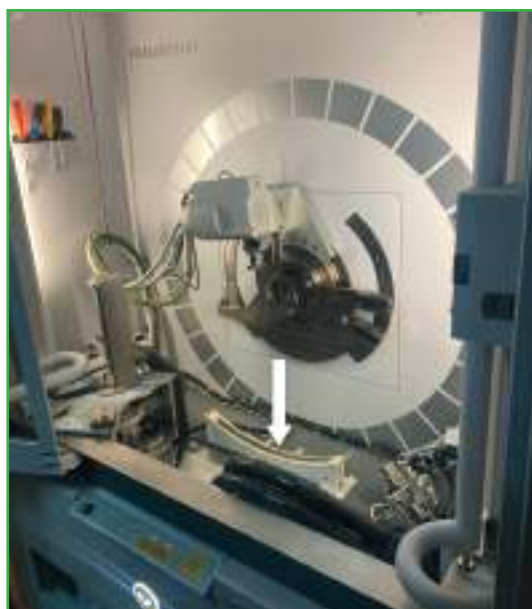
Figura 1: Equipo refractómetro de rayos X perteneciente a la CNEA. La flecha blanca señala el carril con las pupas de Drosophila suzukii durante el proceso de esterilización.
